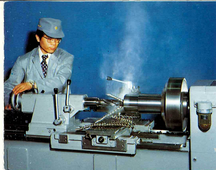
50mmφドリルによる 穴あけ作業
